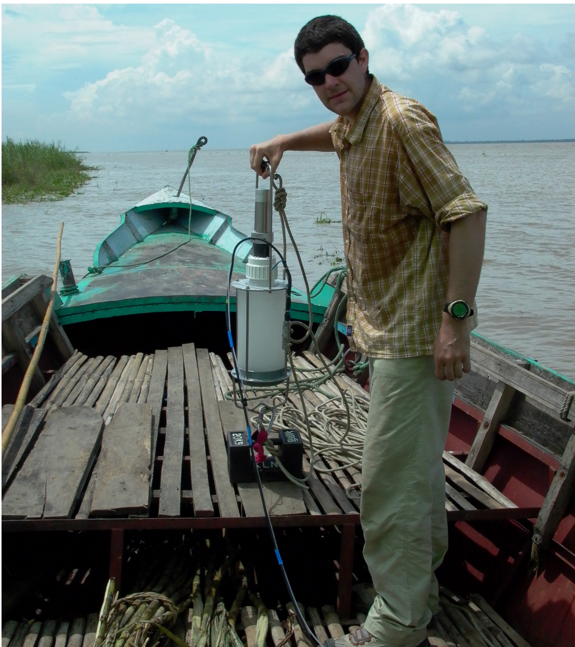
Figure 3.2 : Photographie de l'échantillonneur des matières en suspension utilisé lors des campagnes 2004 et 2005 (version avec commande pneumatique du bouchon).
